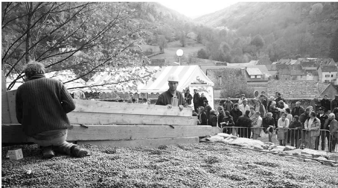
remblai de gravier. Un mur en granite construit par les ABPS dans les règles de l'art : blocs taillés, épais et ajustés, imbriqués les uns dans les autres en opus incertum, c'est à dire sans assise horizontale. L'effet attendu était la rupture sous contrôle (capteurs, systèmes photographiques et de mesure de la déformation...) de ce mur de 2,50 m de hauteur, 4 m de long, épais de 60cm à la base et 45 cm à la cime, et incliné à 6%. Devant un public nombreux, de curieux mais surtout de
