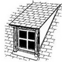
lucarne rampante ou en chien couché
